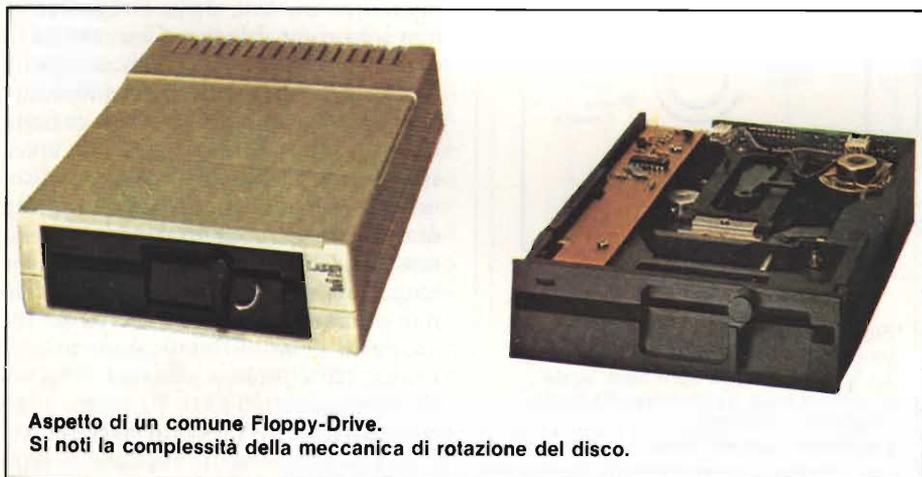
Aspetto di un comune Floppy-Drive. Si noti la complessità della meccanica di rotazione del disco.
