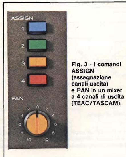
Fig. 3 - I comandi ASSIGH (assegnazione canali uscita) e PAN in un mixer a 4 canali di uscita (TEAC/TASCAM).
